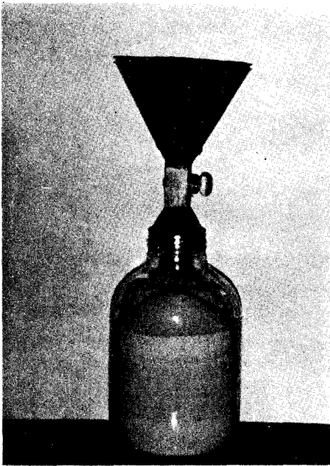
Gambar 8.24. Botol gelas yang dihubungkan dengan kerucut pasir (sand cone) ( catatan : botol diisi dengan pasir Ottawa).
