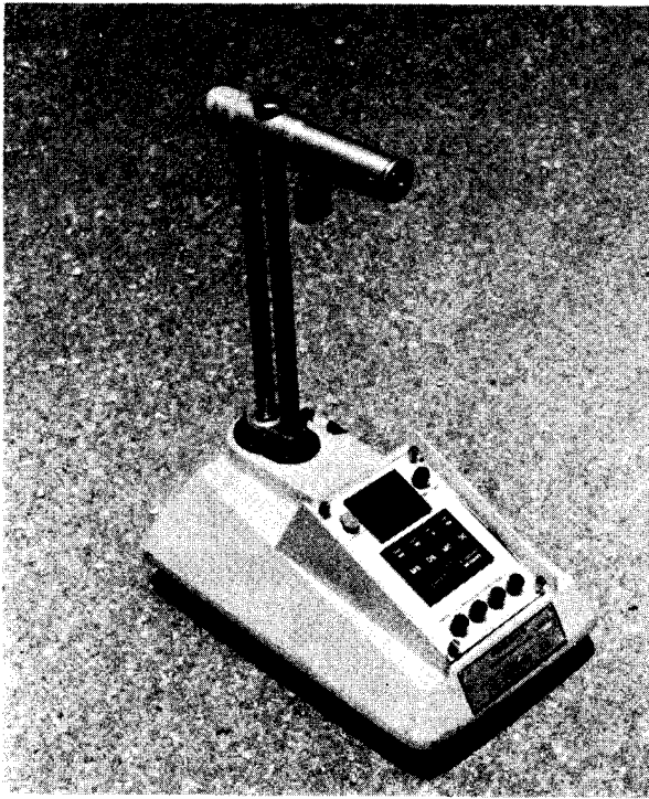
Gambar 8.27. Alat ukur kepadatan nuklir (atas jasa baik David A Carroll, Austin, Texas).
